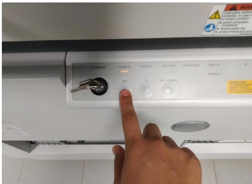
3.33 Naikkan tuil penyejuk untuk mematikan penyejuk peralatan XRD.
